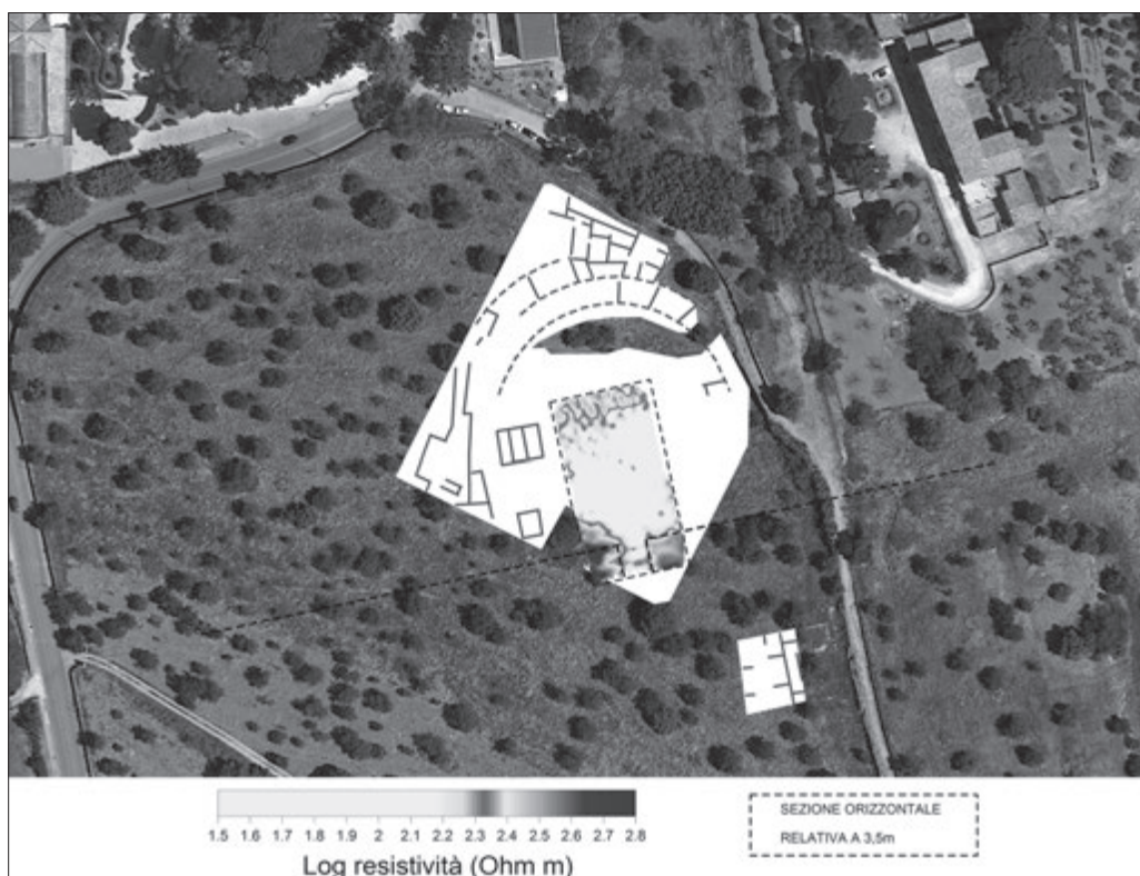
Fig. 22 – Agrigento. Tomografia elettrica con le evidenze dello stenopos centrale (elaborazione M. Cozzolino, E. Di Meo, V. Gentile).
